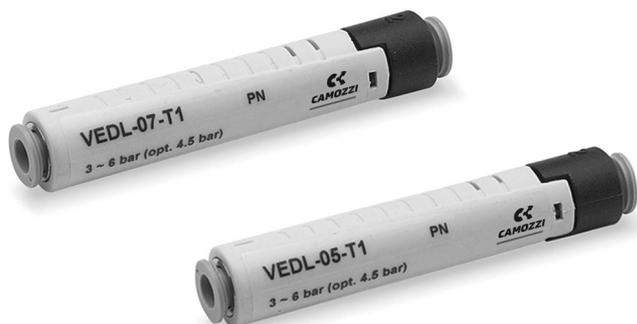
Di solito, questi eiettori per vuoto compatti sono montati direttamente tra la ventosa e l'alimentazione ad aria compressa per ridurre il volume da evacuare e permettere una sostanziale riduzione dei tempi di ciclo.
