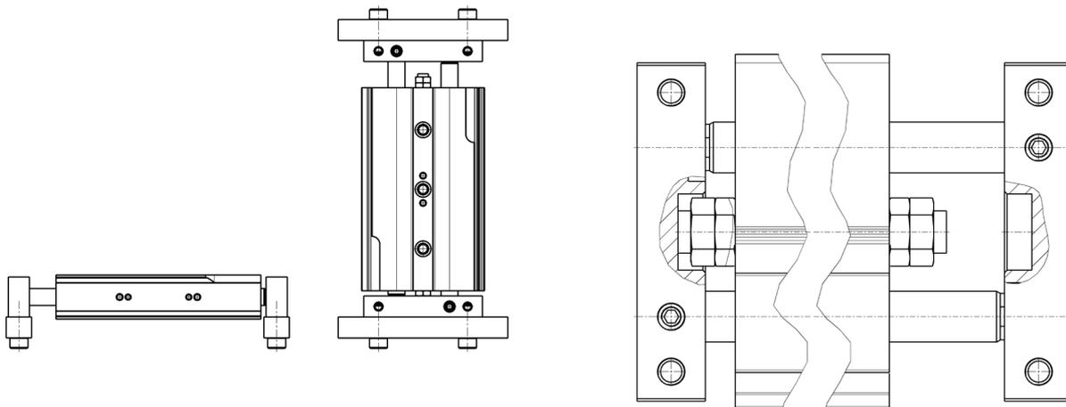
La vite di registro battuta anteriore e posteriore permette di regolare la corsa del cilindro fino a -10 mm per parte.
