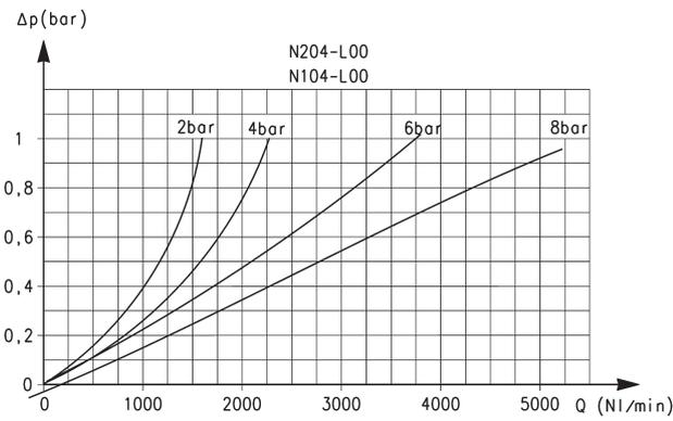
Diagramma di portata per modelli: N204-L00 e N104-L00
