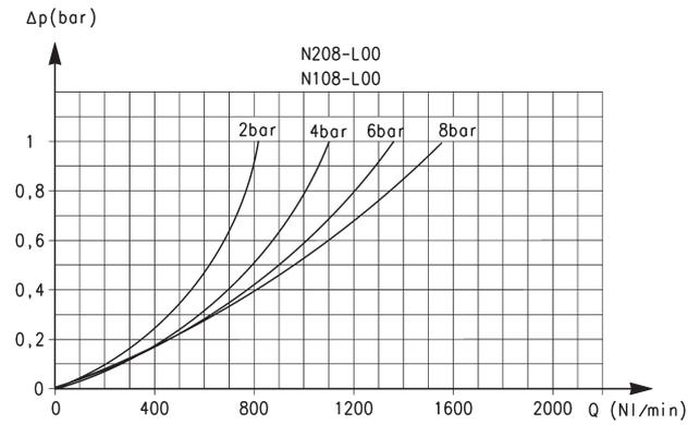
Diagramma di portata per modelli: N208-L00 e N108-L00
