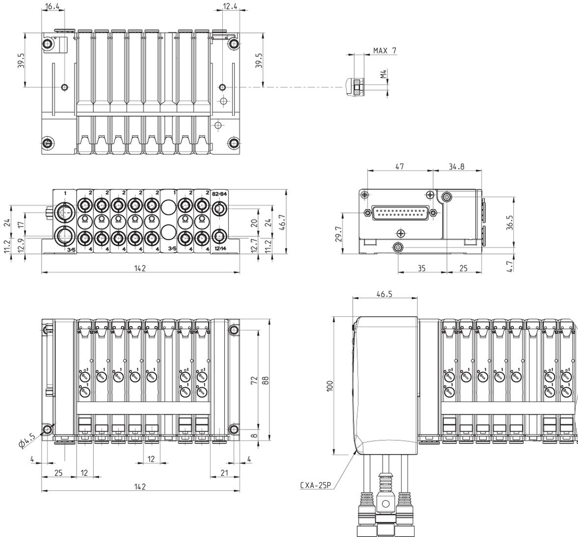
**Versione MULTIPOLARE - DIMENSIONI passo 14 mm**
