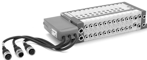
Nella versione Multipolare il collegamento è facilitato dalla posizione frontale del connettore Sub-D a 25 poli. I connettori con cavo pre-cablato, disponibili in diverse lunghezze e con orientamento assiale o radiale, agevolano il collegamento elettrico. L'isola può essere configurata fino ad un max. di 24 solenoidi su 24 posizioni valvola (24 monostabili).
