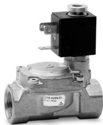
Queste elettrovalvole ad azionamento indiretto, nelle quali l'elettropilota controlla la posizione della membrana attraverso un differenziale di pressione, sono particolarmente indicate per controllare elevate portate di fluido e richiedono pressioni minime di esercizio.
