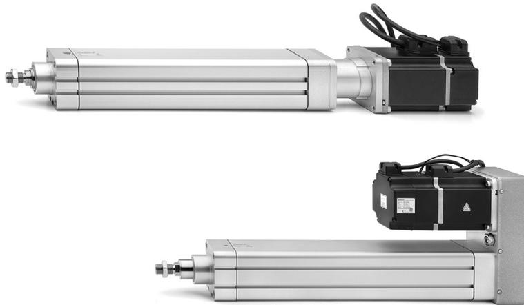
I cilindri Serie 6E sono attuatori meccanici lineari a stelo in cui il moto rotatorio generato da un motore è convertito in un movimento lineare tramite l'utilizzo di una vite a ricircolo di sfere. Disponibile in 6 taglie, la Serie 6E ha le dimensioni basate sullo standard ISO 15552 ed è quindi possibile l'utilizzo di accessori di fissaggio utilizzati per i cilindri pneumatici.
