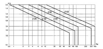
La corsa d'ammortizzo finale deve essere regolata tramite l'apposita vite di regolazione in modo tale da garantire un funzionamento senza urti dell'attuatore. Nelle applicazioni in cui si è al di fuori del range definito dal diagramma è necessario utilizzare un dispositivo esterno (ammortizzatori, arresti meccanici). Quest'ultimi dovranno essere posizionati centralmente rispetto alla massa d'ammortizzare. Il diagramma è da applicare per montaggi in posizione orizzontale.
