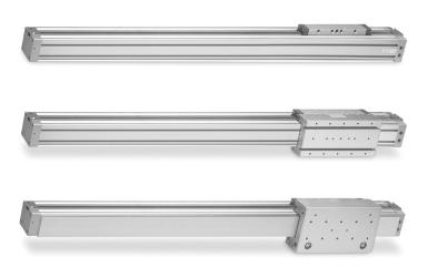
I cilindri senza stelo Serie 52 sono disponibili in 5 alesaggi (25, 32, 40, 50 e 63 mm) e in tre versioni: standard (M), guidata a strisciamento (G)e guidata a rulli (R). Tutte e tre le versioni sono disponibili con carrello standard o carrello corto per coprire una gamma più ampia di applicazioni. La Serie 52 è inoltre disponibile nella versione con alimentazione dell'aria da un solo lato.
