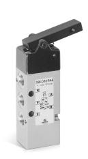
Il particolare dispositivo meccanico permette a queste valvole di fine corsa bassissime forze di azionamento. La Serie 3 è stata costruita con un dispositivo a leva meccanica che lavora in depressione e sulla quale si può applicare una prolunga in acciaio Ø3 per aumentare la sensibilità.
