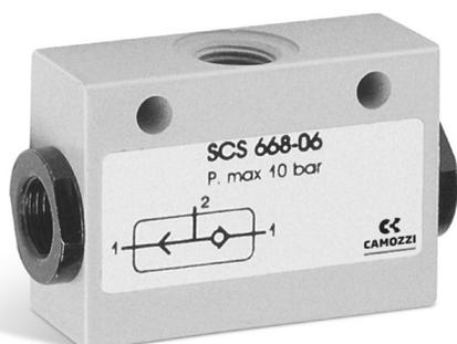
Il selettore di circuito Mod. SCS-668-06 permette di canalizzare due segnali provenienti alternativamente da due punti diversi nello stesso punto.
