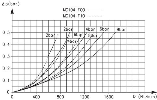
Diagramma di portata per i modelli: MC104-F00 e MC104-F10
