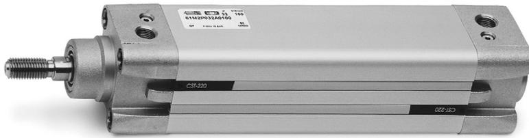
I cilindri Serie 61 sono conformi alla norma ISO 15552 e sono in grado di utilizzare tutta la gamma di accessori standard. Sul profilo sono ricavate, su tre lati parallelamente all'asse di scorrimento dello stelo, le cave per applicare e posizionare i sensori a scomparsa per il rilevamento della posizione del pistone. Queste cave possono essere coperte con un profilo copricava.
